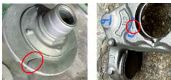
ユザカイ欠陥 ガス欠陥 図1 温度を要因とした不具合例
