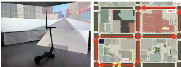
図6 電動キックボードシミュレータ (左:外観、右:仮想環境内の被験者の走行ルート)
