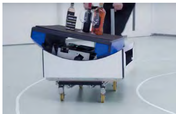
図1 振り子式加速度低減システム(PARS)
