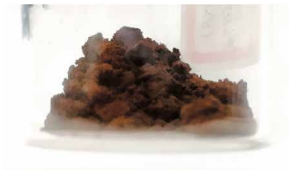
図1 固体冷媒(RbMnFeCoプルシアンブルー)
