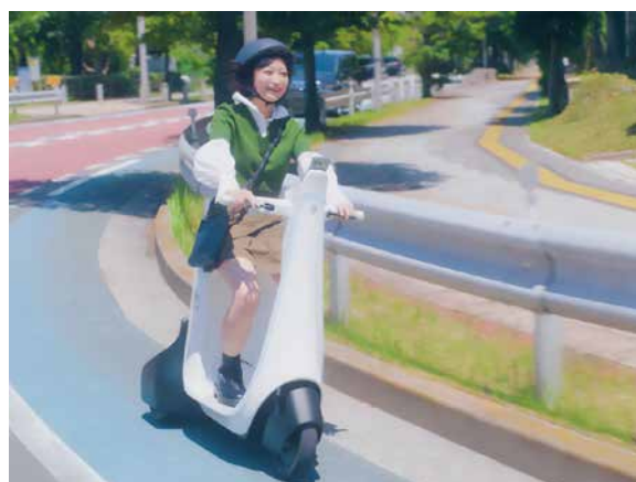
図2 リーンアシスト制御を搭載したUnimo (Luup社共同開発)
