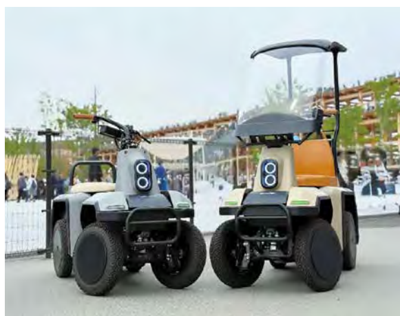
図1 リーンステア制御を搭載したWAKUMOBI (glafit社共同開発)
