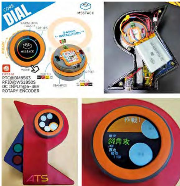
図10 作戦送信機（パーマンバッチ型）
