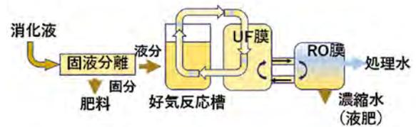
図13 消化液浄化フロー図
