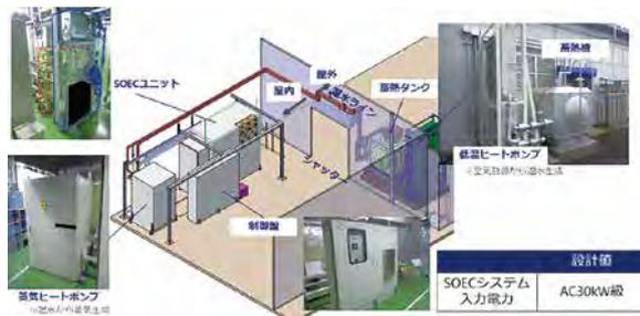
図11 AC30kW級SOECシステム概要
