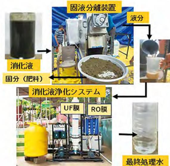
図14 消化液浄化システム写真
