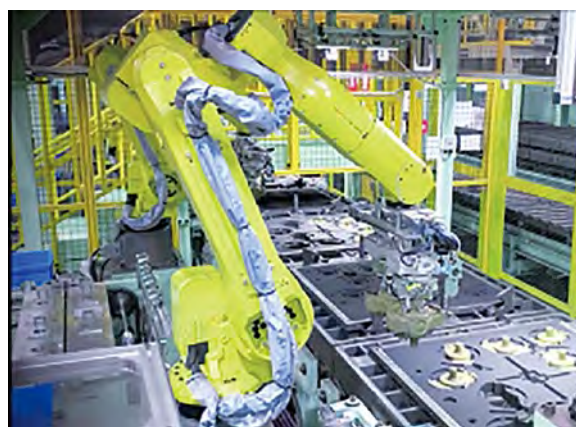
図9 中子納め自動化設備
