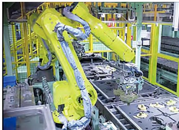
図9 中子納め自動化設備
