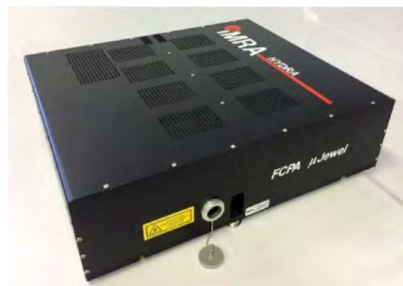
図2 使用したフェムト秒ファイバーレーザー (イムラアメリカ製)
