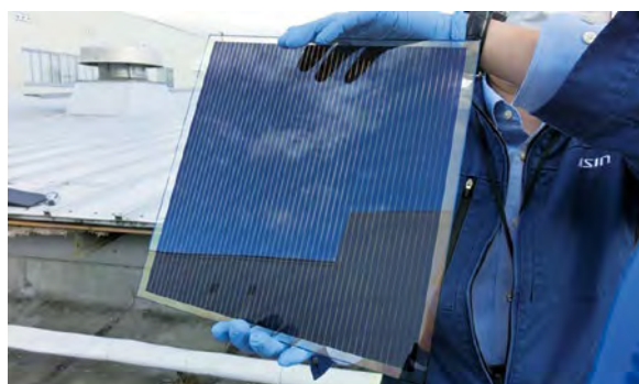
図6 実用化サイズのペロブスカイト太陽電池
