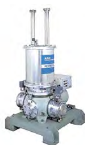
図2 スターリング冷凍機
