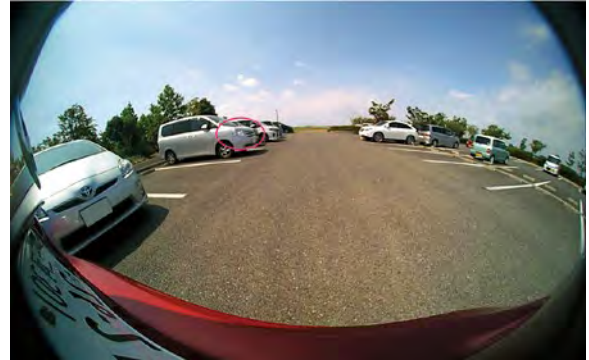
図4 遮蔽により空き駐車区画であると誤認する状況
