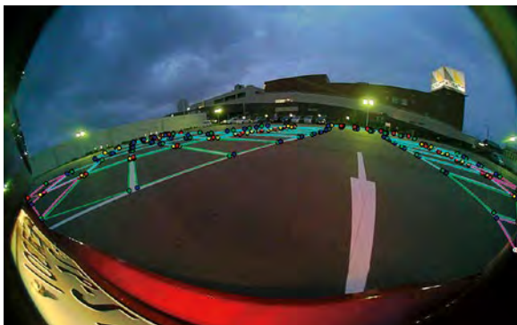
図3 駐車区画正解値座標例 四隅座標が見えない場合は白線可視部の先端の点を代替座標とする
