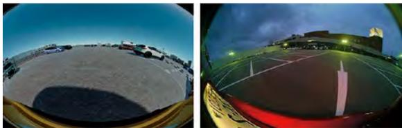
図10 シミュレータ画像と実写画像の比較
