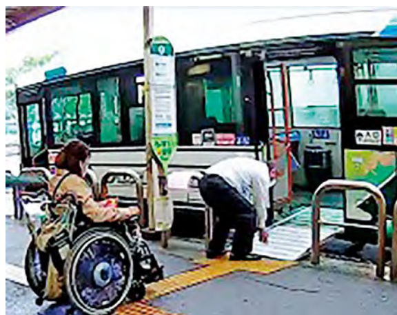
図1 スロープ設置風景(手作業)
