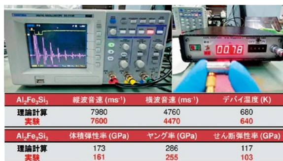
図4 FAST材料の音速測定結果と機械特性 3)
