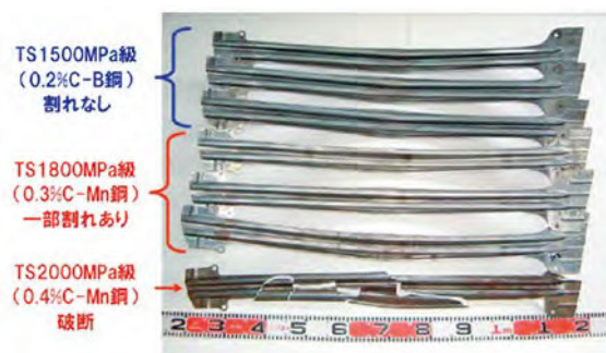
図3 開発初期の試作品での3点曲げ試験後外観
