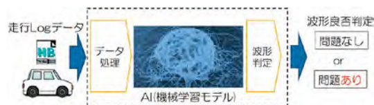
図5-4 走行データ波形の良否を自動判定する仕組み
