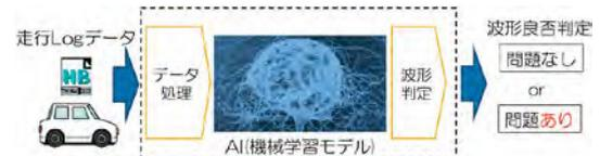
図5-4 走行データ波形の良否を自動判定する仕組み
