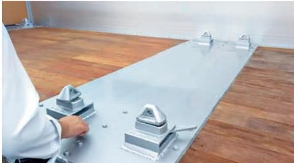
図7 ツイストロックによる固縛方法
