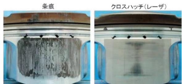
図11 試験後のピストンスカートの外観
