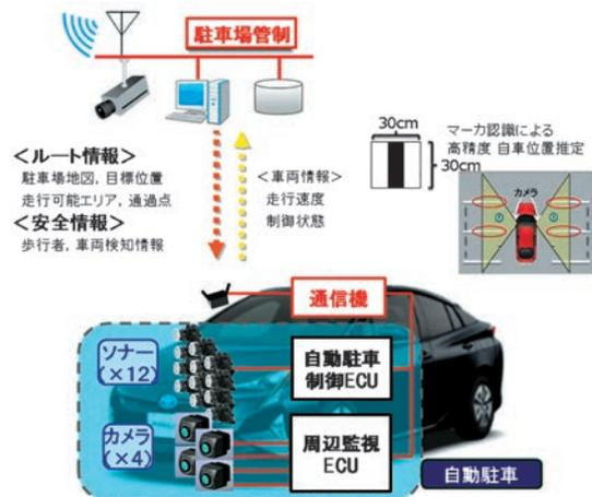
図1 自動バレー駐車システムの構成
