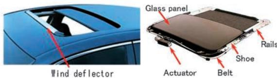
図1 サンルーフ搭載状態 図2 サンルーフ詳細
