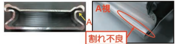
図5 割れ不良部位
