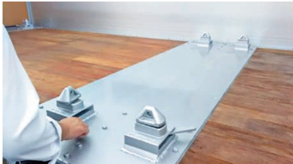
図7 ツイストロックによる固縛方法
