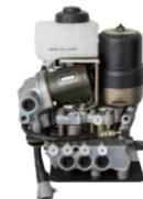
電動式四輪アンチロックブレーキシステム(1987年)
