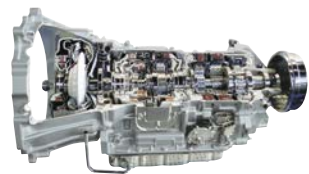
小型トラック・バス用FR6速 オートマチックトランスミッション
