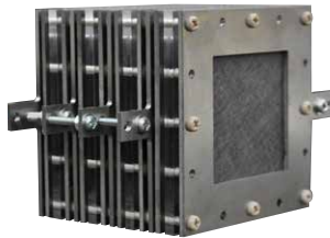
試作したLi-空気二次電池スタック(4セル)
