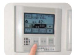
モニター家庭に設置した試作機の台所リモコン。発電量やCO<sub>2</sub>の削減効果、経済効果も見ることができる。
