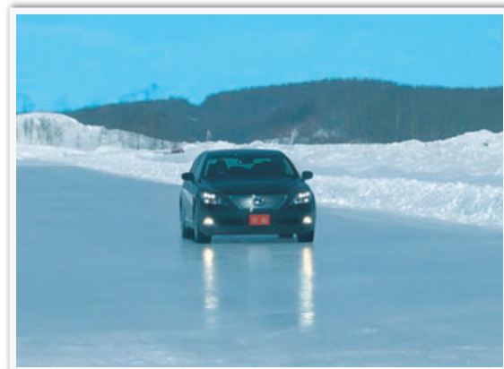
氷結路でのブレーキ性能評価による信頼性評価試験
