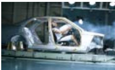
最新の法規制に対応した低速から高速衝突までを再現できるスレット試験装置
