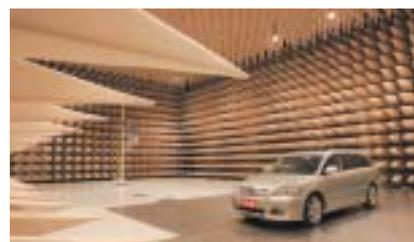
電子機器への電磁波の影響を評価する電波暗室(藤岡)
