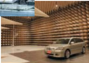
電子機器への電磁波の影響を評価する電波暗室(低周波から高周波数帯域にも対応)
