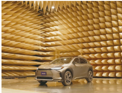
電子機器への電磁波の影響を評価
