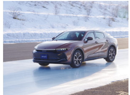
人工氷結路での車両安定性評価
