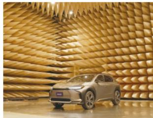
電子機器への電磁波の影響を評価
