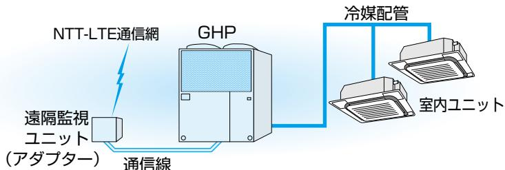
株式会社NTTドコモのNTT-LTE通信網を利用するため、新たに設置する機器は「遠隔監視ユニット」のみで施工は簡単・低コストで済みます。
