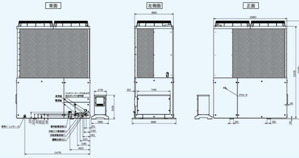
室外ユニット GHPハイパワープラス 外形図・システム例
