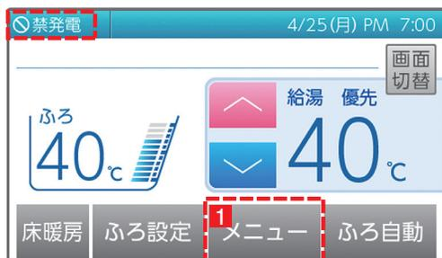
「発電禁止」操作により発電停止しています。
