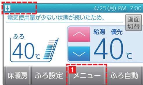
電気使用量が少ない状態が続いたため、1か月間発電を停止しています。
