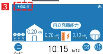
使用電力が少ない状態がしばらく続くと発電電力を下げる場合があります。使用電力の大きい電化製品を使用される場合は、以下の手順により発電出力を最大約700Wまで上げることができます。
