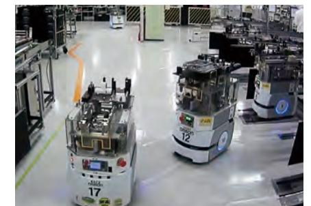
生産状況とAGV(無人搬送車)の稼働状況等をリアルタイムに取得し、それに基づいた最適な運搬計画をシステムで生成・配信することで、AGVの自律的な運搬を実現
