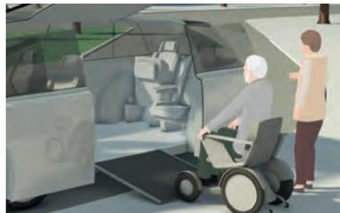
大開口ドアに電動スロープを組み合わせ、
