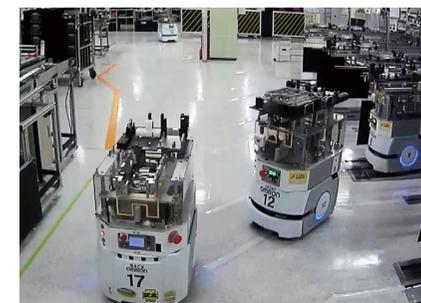
生産状況とAGV(無人搬送車)の稼働状況等をリアルタイムに取得し、それに基づいた最適な運搬計画をシステムで生成・配信することで、AGVの自律的な運搬を実現
