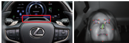
ドライバーモニターシステム (トヨタ自動車株式会社 LEXUS LS Advanced Drive搭載車)
