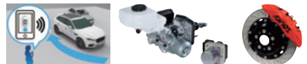
自動駐車システム 回生協調ブレーキ ディスクブレーキ
