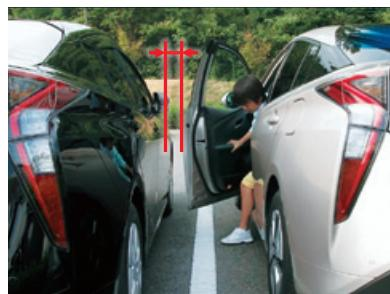
隣の車両を検知しドアがぶつからないように自動制御
