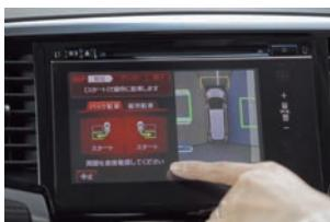
駐車枠を自動認識し、モニターで駐車位置を選択
