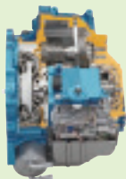
中容量FF6速AT(TF-70SC) ※Lepelletier方式に基づく アイシン・エイ・ダブリュ
