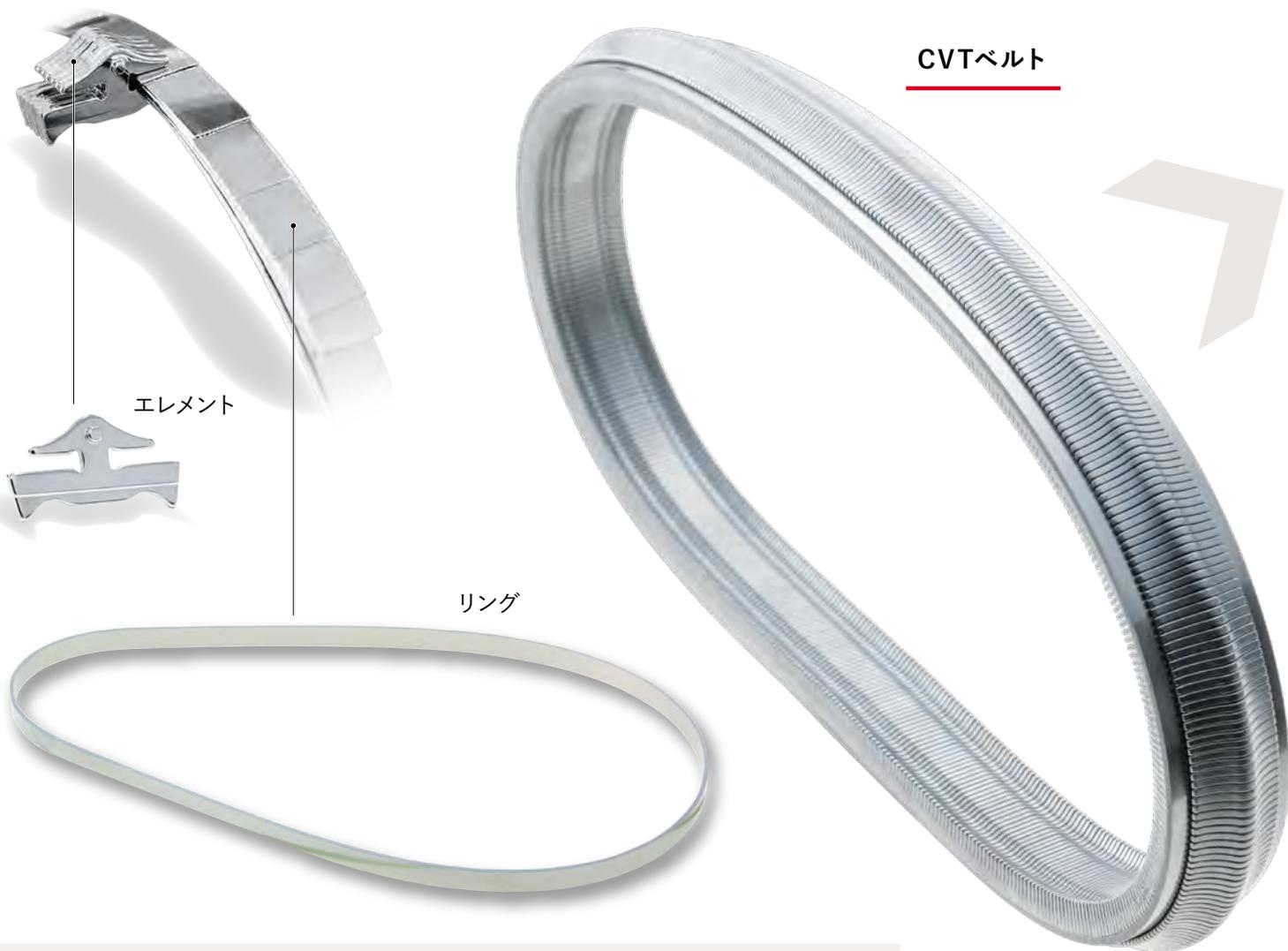
当社が製造するCVTベルトは、「エレメント」と「リング」という二つの部品で構成されています。エレメントは、エンジンからの動力をスムーズに伝え、且つノイズを極力抑える必要があるため、非常に厳しい寸法精度が求められます。また、エレメントを束ねるリングは、高い強度としなやかさを実現するために特殊鋼を多層に重ね、層間の隙間も数ミクロンという高精度で管理されています。
