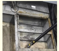
クーラントタンクに 沈殿した切粉回収
